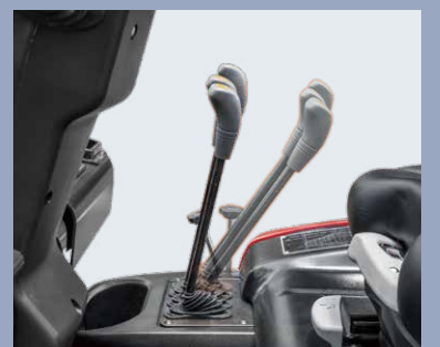
Die Abdeckung kann leicht geöffnet werden, indem man die Hebel nach vorne stellt
