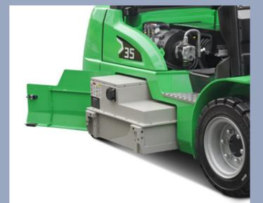
Einfache Batterie Entnahme
